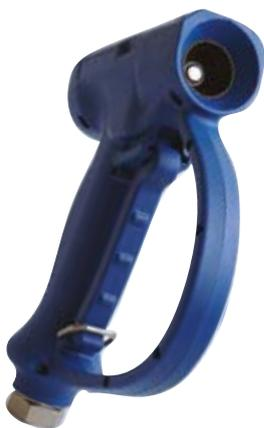
Sehr leichte Reinigungspistole für Reinigungszwecke in der Lebensmittelindustrie, im Gewerbe und in Werkstätten. Robustes Gehäuse aus Polypropylen mit Glasfaser verstärkt. Die Strahlform – stufenlos vom Vollstrahl bis zum feinen Sprühnebel – lässt sich an der Regulierschraube einstellen. Für Dauerbetrieb arretierbar. Sicherheitsbügel zum Schutz des Bedienhebels.
